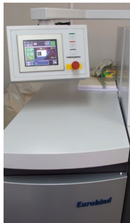
La Eurobind 600 está equipada con cambio de formato automático y pantalla táctil en el panel de control
